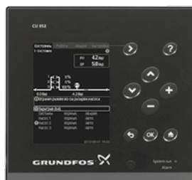
› Большой список дополнительных опций шкафа управления в установках Hydro MPC, а также удобное меню с графическим дисплеем и встроенной функцией текстовой помощи для каждого пункта меню
